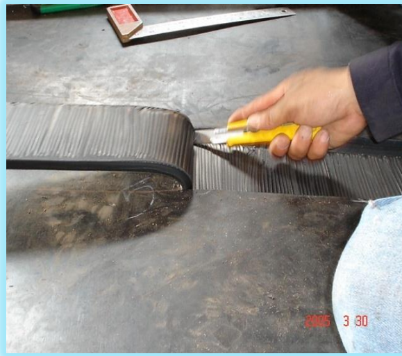
ผิวของสายพาน (Rubber Cover) แบบเรียบลอกออกมาให้ดู
